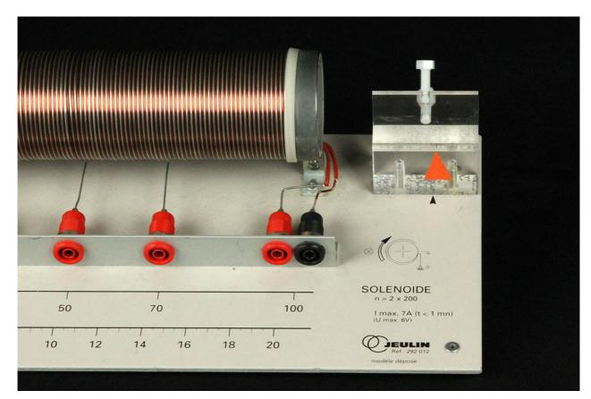
Sur l'avant de l'appareil, les différentes sorties de l'enroulement E2 sont accessibles. Les branchements doivent être effectués de façon symétrique par rapport au centre du solénoïde.
