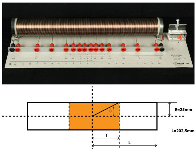
Sur la droite des enroulements, il a été prévu un guide D adapté à la sonde C du teslamètre ; grâce à une graduation du manche porte-sonde, il est possible de repérer la distance de la sonde au centre du solénoïde, par lecture directe.
