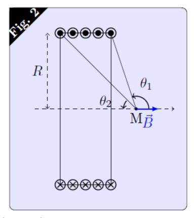
Le sens du courant électrique définit ici la direction de l'axe de la bobine. Inverser le sens du courant revient à inverser la direction de  $\vec{B}$ .
