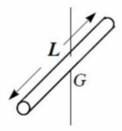
Calculer le moment d'inertie,  $I_1$  et  $I_2$ , des deux tiges, à partir de la relation donnant le moment d'inertie d'une tige homogène de longueur L autour d'un axe lui étant perpendiculaire et passant par son centre de gravité (G):
