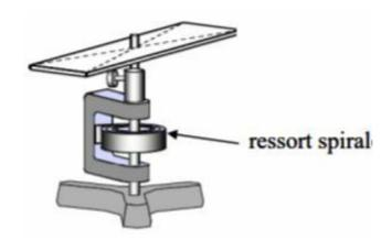
Le dispositif expérimental de ce TP est constitué du solide à étudier placé sur une balance de torsion oscillante animée par un ressort de rappel en spirale possédant une constante élastique de torsion C qu'il faudra préalablement déterminer.
