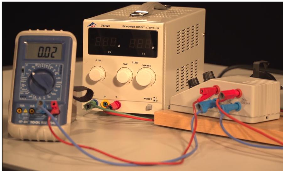
Si la tension appliquée sur le moteur est constante, cette valeur est proportionnelle à la fréquence excitatrice qui se règle via les deux boutons (réglage grossier et réglage précis ; voir figure ci-dessous)
