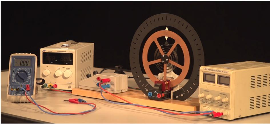
Les deux autres bornes servent à mesurer la tension d'excitation du moteur à l'aide d'un multimètre (voir figure ci-dessous).
