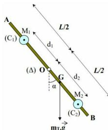
Le pendule à étudier est constitué d'une tige et d'autres accessoires dont deux barreaux horizontaux placés à la même distance de l'axe de rotation.
