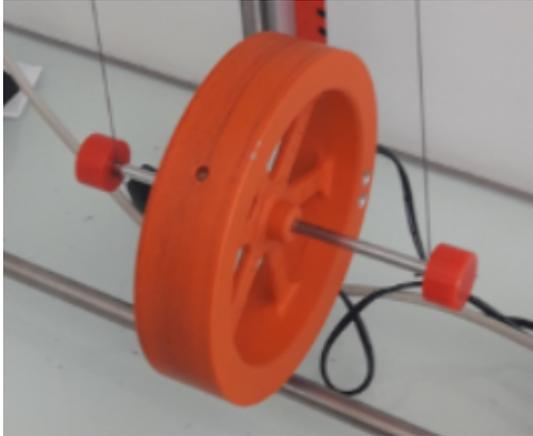
Dans ce TP on se propose d'étudier le principe de conservation d'énergie mécanique en mesurant la transformation d'énergie potentielle en énergie cinétique de translation et de rotation. Nous allons aussi déterminer le moment d'inertie de la roue de Maxwell.
