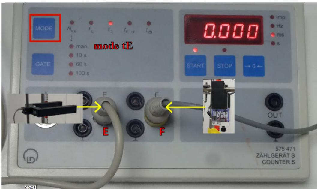
1. Mesure du temps  $\Delta t$  pour calculer la vitesse de translation  $v$ , au niveau de la barrière lumineuse
